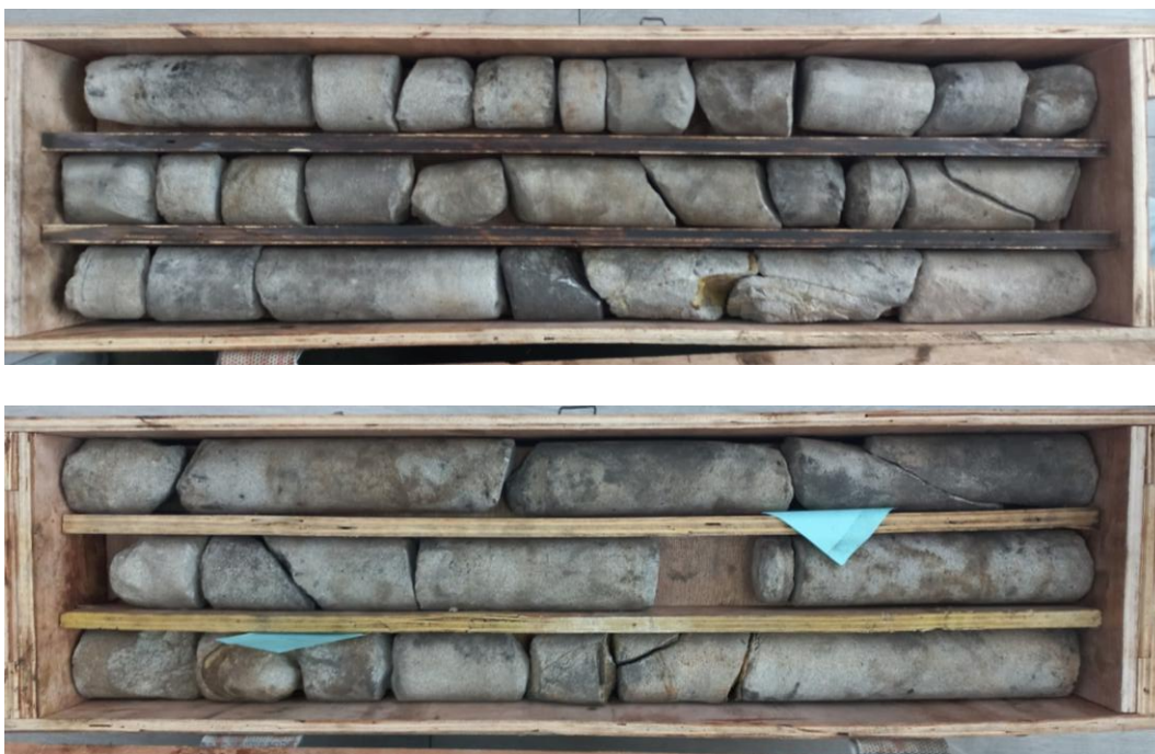
Рисунок 3.3 – Приклад фотодокументації відібраного керна зразка порід покрівлі, що представлена пісковиком
