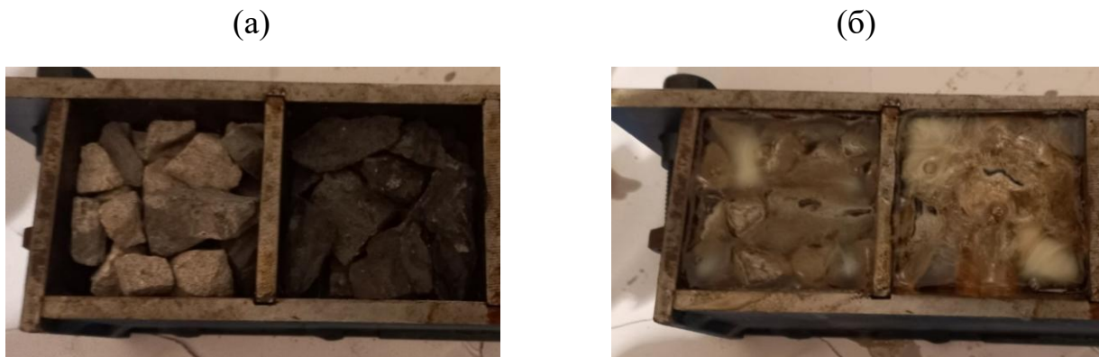
Рисунок 2.8 – Загальний вигляд фракцій пісковика та алевроліту в металевій формі: (а) розміщені фракції порід; (б) фракції порід, скріплені поліуретановою смолою
