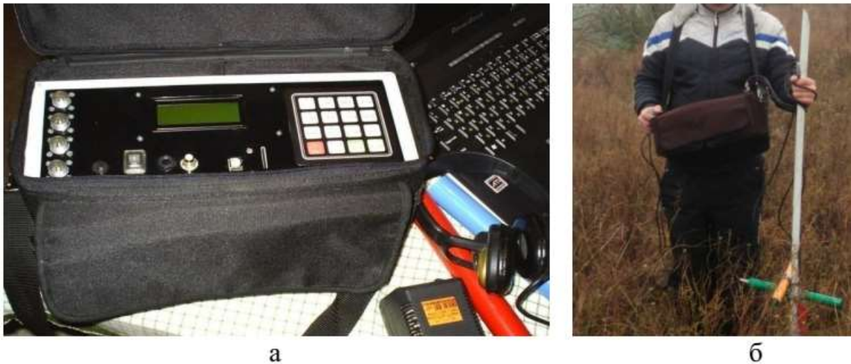
Рисунок 2.1 – Зовнішній вигляд приладу МІЕМП-14/4 (а) та споряджена апаратура (б) у складі власне приладу та вимірювальної штанги з трьома антенами [78]
