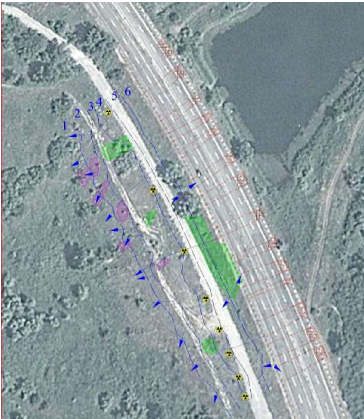
Рисунок 3.32 – Натурна прив'язка зон фільтрації води, виділені за результатами схеми зйомки ПЕМПЗ у верхній дамбі хвостосховища «Сухачівське» 1 секція.
