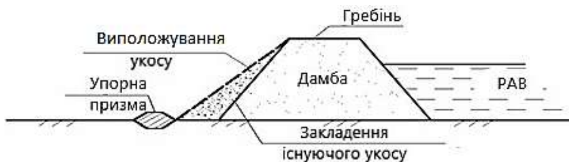
Рисунок 5.10 – Забезпечення стійкості низового укосу завдяки виположуванню укосу і влаштуванню упорної призми (зуба)
