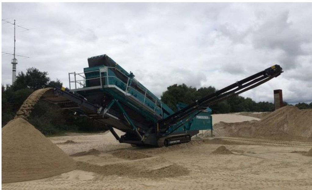
Рис. 1.9. Загальний вигляд однодекової мобільної сортувалки Powerscreen Chieftain 2100X продуктивністю до 600 т/год.
