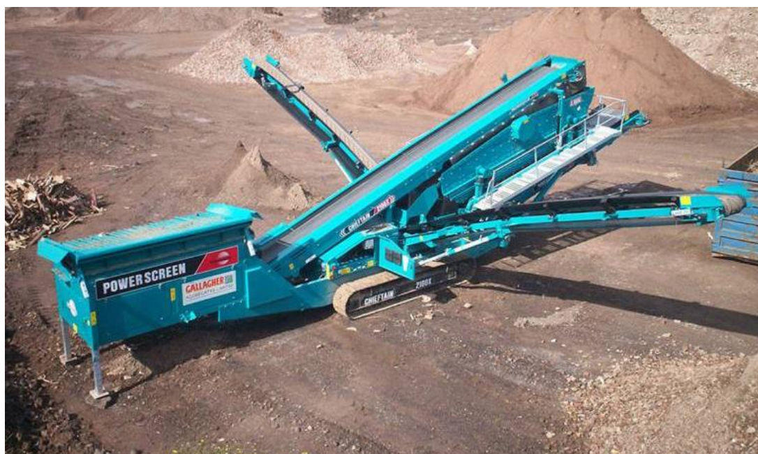
Рис. 1.10. Загальний вигляд дводекової мобільної сортувалки Powerscreen Chieftain 2100X Bivitec продуктивністю до 400 т/год
