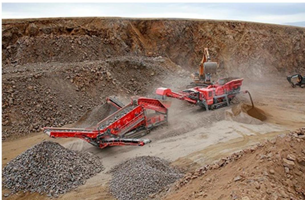
Рис. 1.11. Комплекс МДСУ від TEREX в кар'єрі
