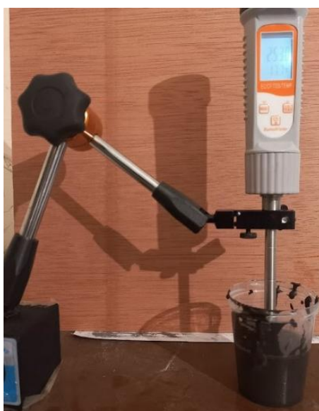
Рисунок 3.8 – Моніторинг величин електропровідності пастової закладної суміші кондуктометром ВТ 761
