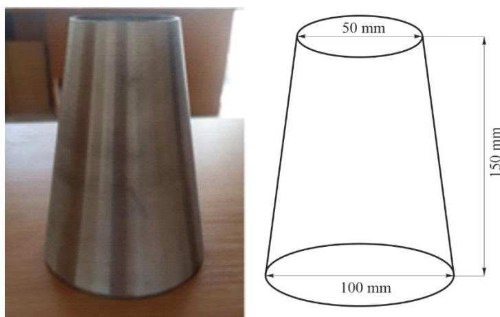
Рисунок 3.11 – Виготовлений металевий міні-конус для дослідження величини осідання суміші
