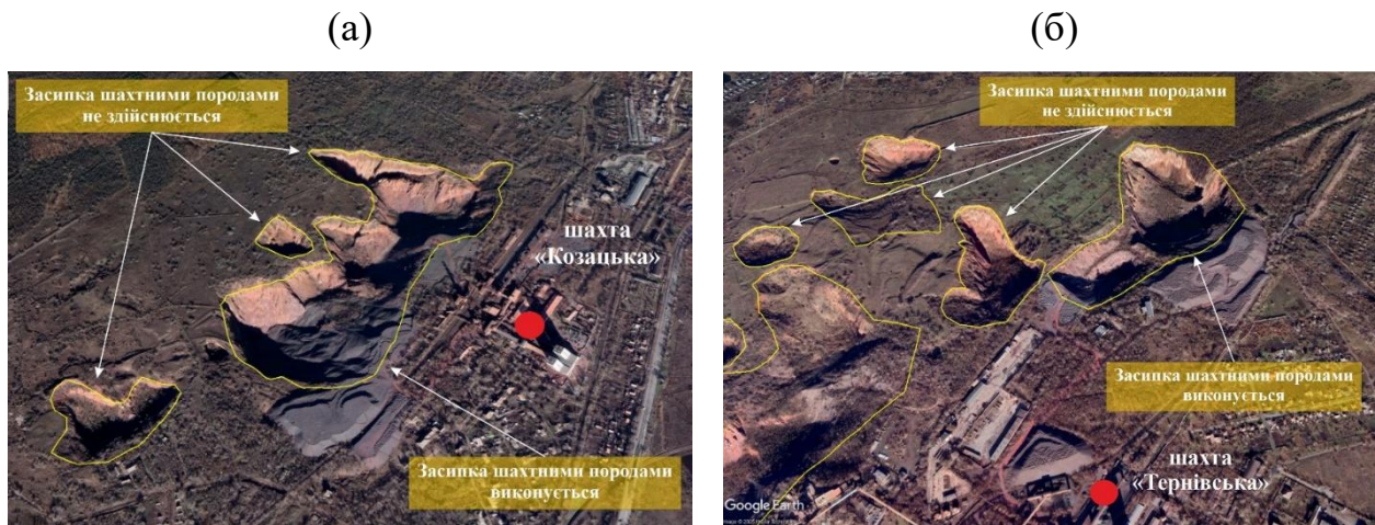
Рисунок 1.16 – Засипання пустими шахтними породами основних провальних зон шахт: (а) ш. «Козацька»; (б) ш. «Тернівська»
