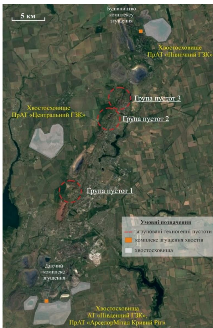
Рисунок 7.2 – Взаємне розташування хвостосховищ та груп техногенних пустот, готових до закладання в умовах Кривбасу
