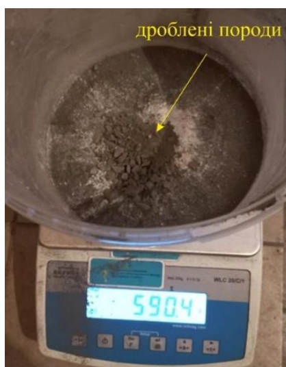
Рисунок 3.5 – Ілюстрація процесу додавання дроблених порід у пастову суміш на стадії її виготовлення
