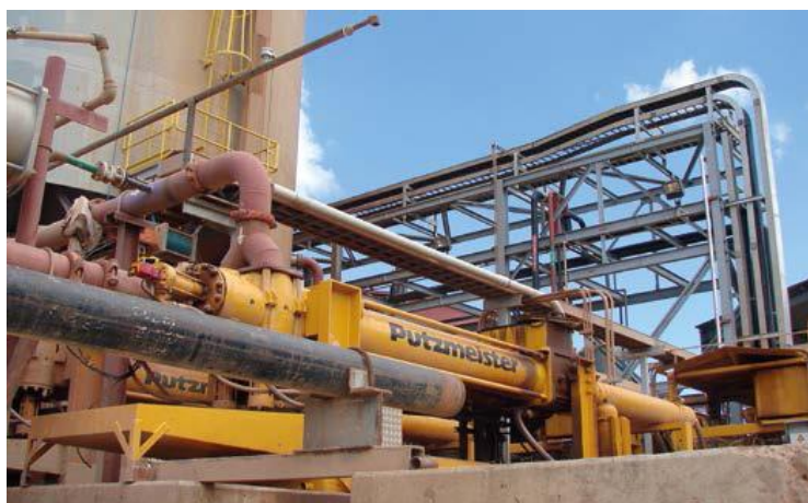
Рисунок 7.11 – Загальний вигляд високонапірного поршневого насосу типу HSP виробництва Putzmeister, встановленого на закладному комплексі [314]
