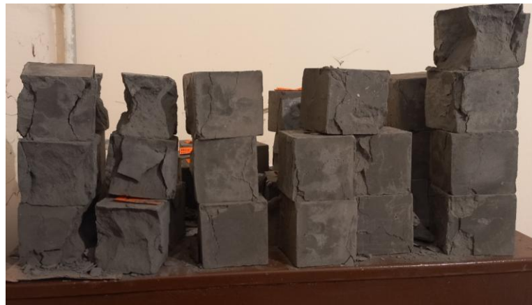
Рисунок 5.14 – Ілюстрація партії випробуваних на міцність кубічних зразків
