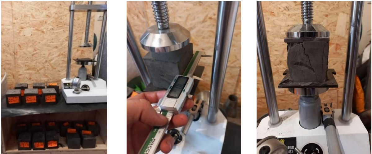
Рисунок 5.13 – Дослідження міцності на стиск зразків закладного масиву
