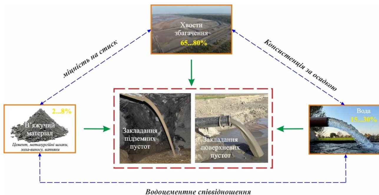
Рисунок 2.16 – Структура та взаємозв'язок між компонентами цементованого пастового закладання
