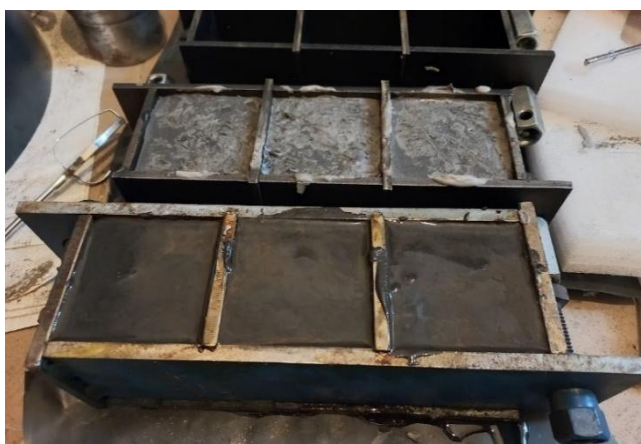
Рисунок 3.6 – Закладні суміші, розміщені у металевих формах ЗФК-70
