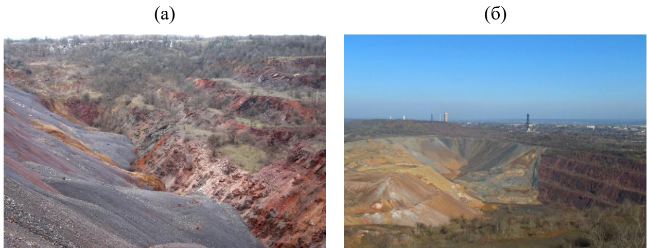
Рисунок 1.20 – Засипання пустими кар'єрними та шахтними породами відпрацьованих кар'єрних пустот у КЗБ: (а) кар'єр колишнього РУ «Ім. Ілліча»; (б) кар'єр № 1 ПрАТ «Центральний ГЗК» (фото Д. Антонова, 2011, 2014 рр.)
